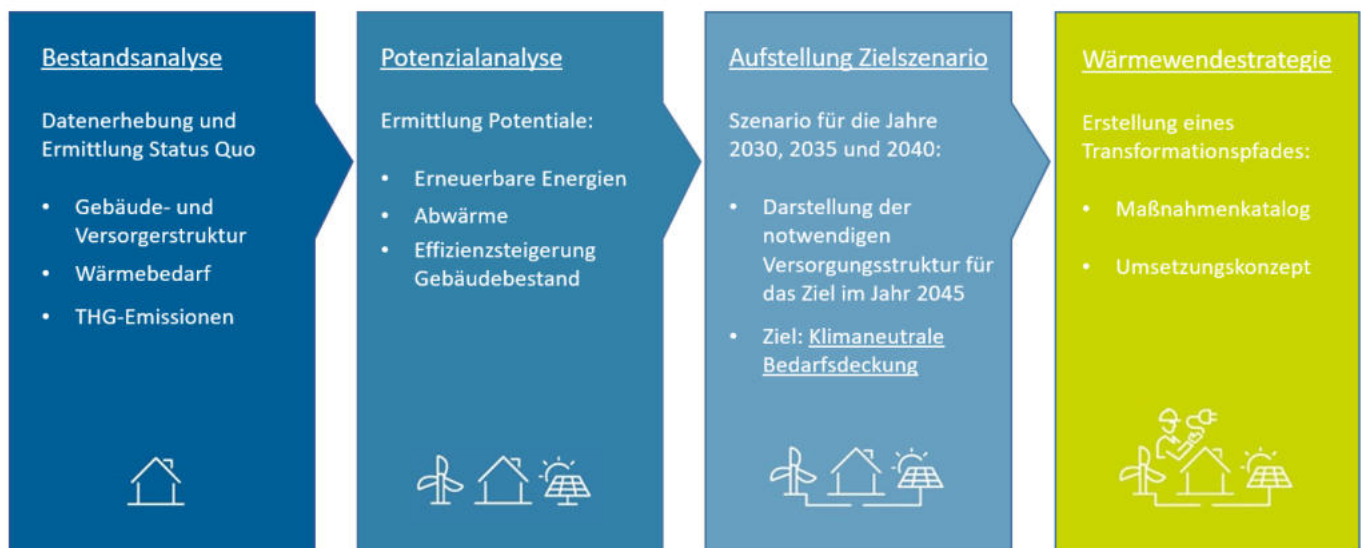
Abbildung 1 Schematischer Aufbau der kommunalen Wärmeplanung
